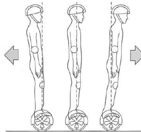
Scooteren har et indbygget inert-stabiliseringssystem, der holder balancen ved fremadgående og baglæns retning, men det kan ikke garantere stabiliteten i venstre og højre retning. Derfor skal man undgå at dreje skarpt med høj hastighed, for at undgå farlige situationer. Undgå at flytte dig sideværts eller skifte retning på en skråning: det vil påvirke scooterens balance.
