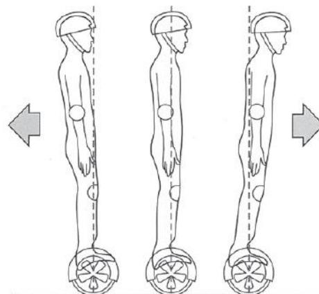
Lo scooter è in grado di mantenere un equilibrio anteriore e posteriore ma non di garantire quello laterale. Per questa ragione, le manovre di svolta necessitano di essere effettuate ad una velocità ridotta. Diversamente, il conducente potrebbe perdere il controllo del veicolo e riportare danni a causa dell'azione della forza centrifuga.
