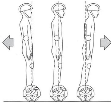
Skotern har ett inbyggt tröghetssystem som håller balansen vid körning framåt och bakåt men kan in garantera stabiliteten i riktningarna vänster och höger. Sväng därför inte för tvärt med hög hastighet för att undvika farliga situationer. Flytta inte kroppens tyngdpunkt åt sidan och sväng inte på en sluttning: att göra det kommer att påverka balansens jämviktsvinkel för skotern.
