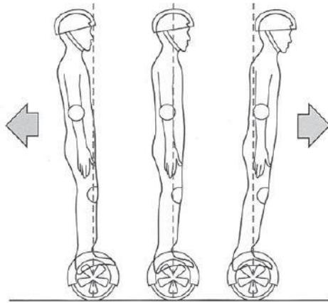
Tohjulingen har et innebygget treghetsmomentssystem for stabilitet som holder balansen fremover og bakover, men det kan ikke forsikre stabiliteten mot venstre eller høyre. Brukeren bør derfor ikke svinge under høy hastighet, dette er for å forhindre farlige situasjoner. Brukeren bør ikke endre kjøreretning i en bakke da dette vil ha innvirkning på balansevinkelen til tohjulingen.
