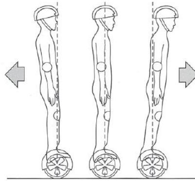
Tasapainoskootterissa on sisäänrakennettu hidastumisvakavuusjärjestelmä: se säilyttää tasapainon eteen- ja taaksepäin suuntautuvissa liikkeissä muttei pysy varmistamaan vakavutta vasemmalle ja oikealle käännyttääessä. Älä siis muuta suuntaa nopeasti suuressa nopeudessa, niin vältät vaaratilanteet. Älä siirrä painoa sivusuunnassa äläkä vaihda suuntaa mäessä: toiminto vaikuttaa tasapainoskootterin tasapainon kulmaan.
