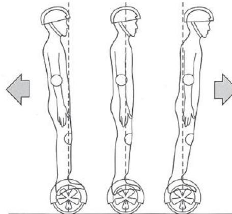
Der Roller verfügt über ein integriertes Stabilisierungssystem, um Vorwärts- und Rückwärtsbewegungen auszugleichen. Die Stabilität bei Links- oder Rechtsbewegungen kann jedoch nicht garantiert werden. Biegen Sie daher nicht bei hohen Geschwindigkeiten ab, um Gefahrensituationen zu vermeiden. Auf Hängen nicht seitlich bewegen oder abbiegen: dadurch würde der Gleichgewichtswinkel des Rollers beeinträchtigt.
